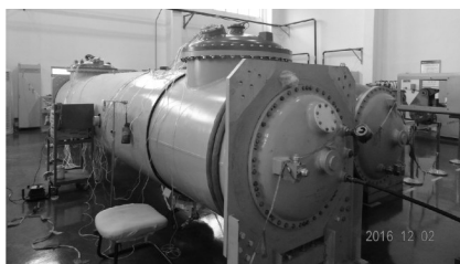
图16 加装辅助加热装置的断路器温升
