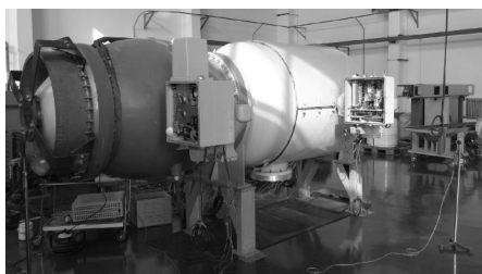
图18 加装辅助加热装置的隔离开关温升
