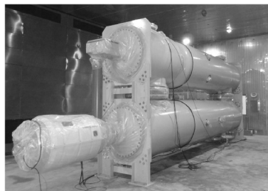
图8 断路器低温试验形态
